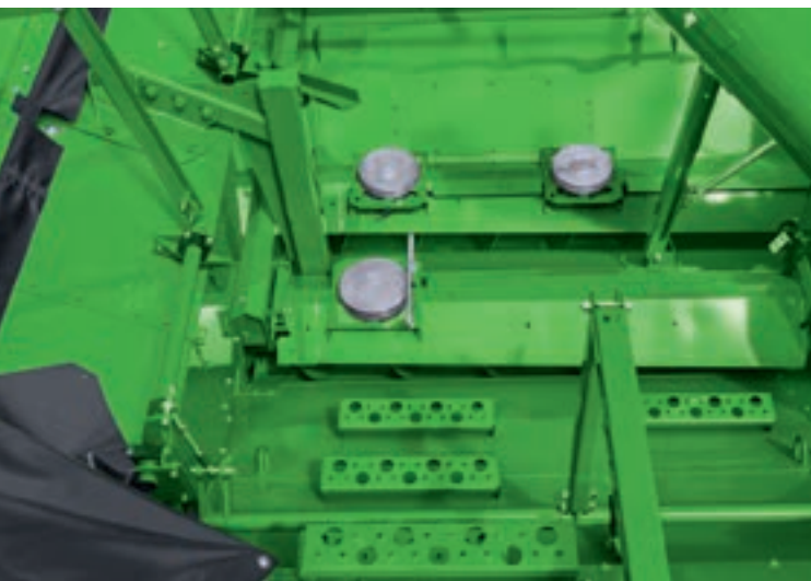
Tri snímače merajú hmotnosť zrna.
