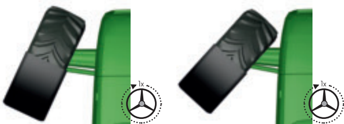
Riadenie s variabilným pomerom vypnuté
