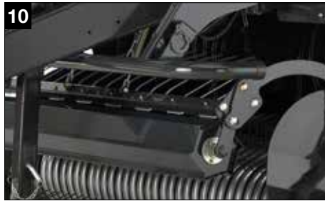
Velký válec na plodiny (Ø 217 mm)
